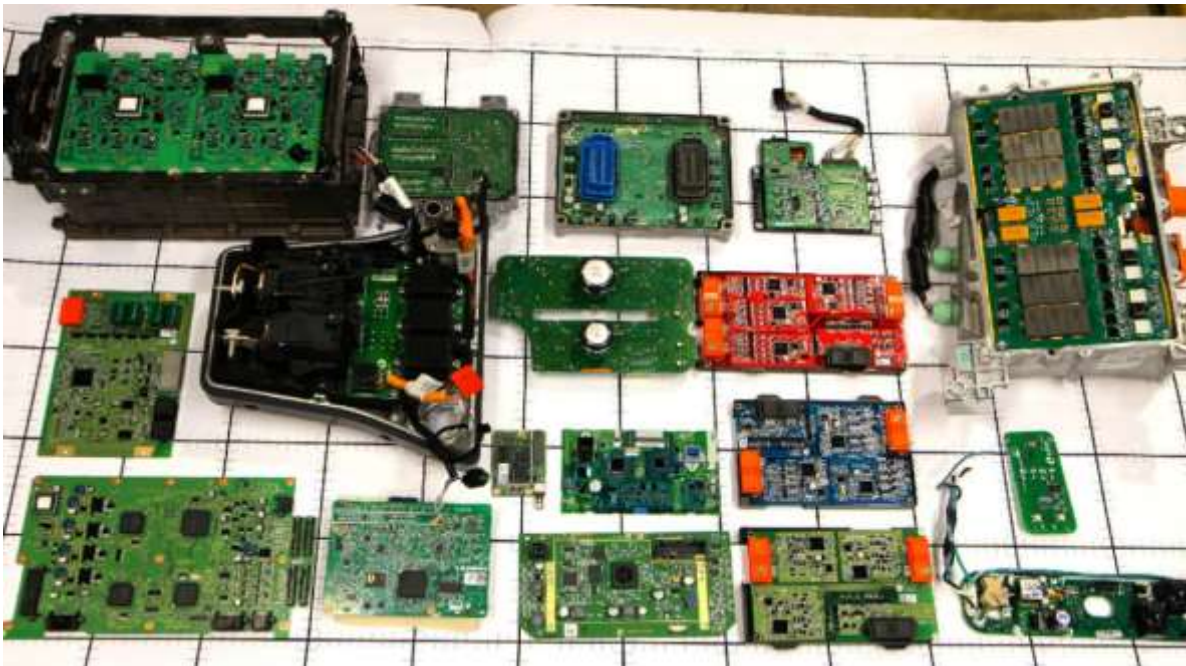
Fig 61: The Chevy Volt BMS 110
