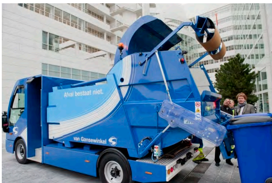
Fig. 23.2 “Binky,” small full-electric garbage collecting truck by Spijkstaal. (Photo courtesy of Spijkstaal.)
